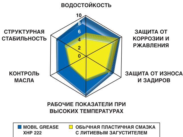
Пластичные смазки серии Mobilgrease XHP эффективно работают в отношении всех ключевых эксплуатационных факторов для обеспечения безотказной работы подшипников в самых разнообразных видах промышленного оборудования. Смазки Mobilgrease XHP отличаются отличной водостойкостью и высокой нагрузочной способностью, а также обеспечивают долгосрочную защиту от ржавления и коррозии. Они демонстрируют значительно более высокие эксплуатационные характеристики в сравнении с обычными литиевыми смазками.
